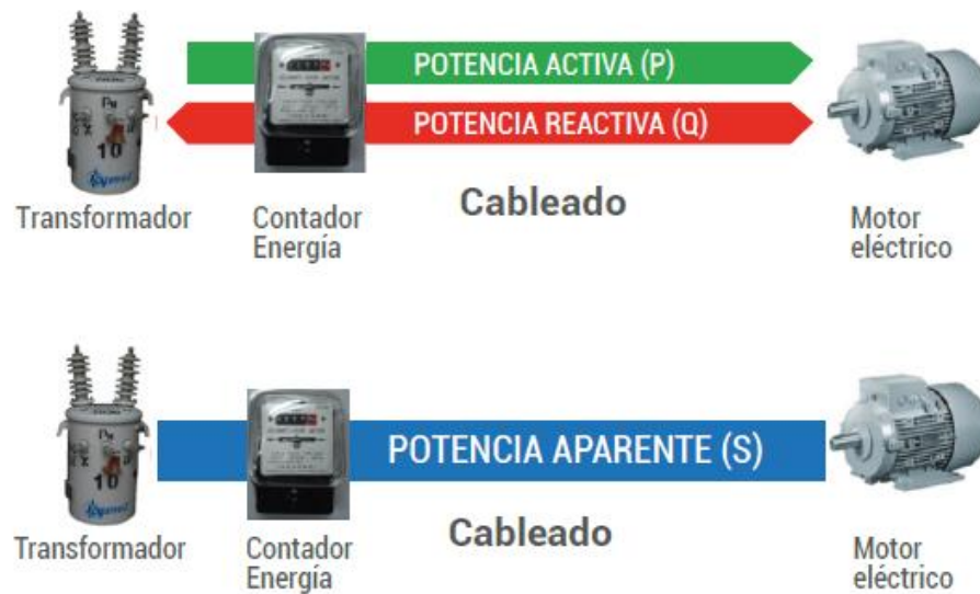
Figuras 4. Potencia activa, reactiva y aparente. [1]
