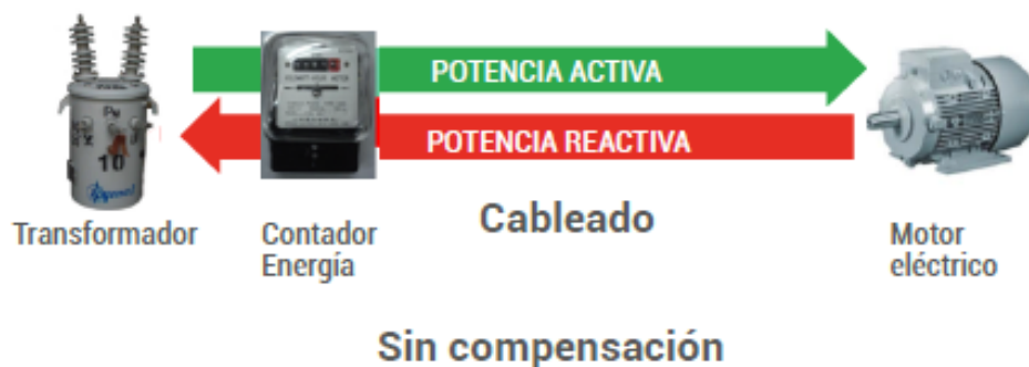
Figuras 14. Instalación sin corrección del factor de potencia. [1]
