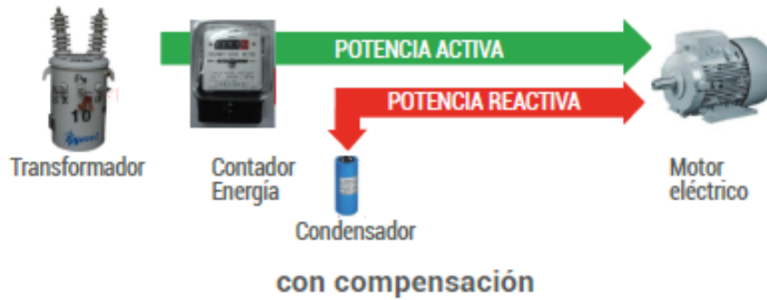
Figuras 15. Corrección del factor de potencia en el punto de acometida principal o contador de energía. [1]
