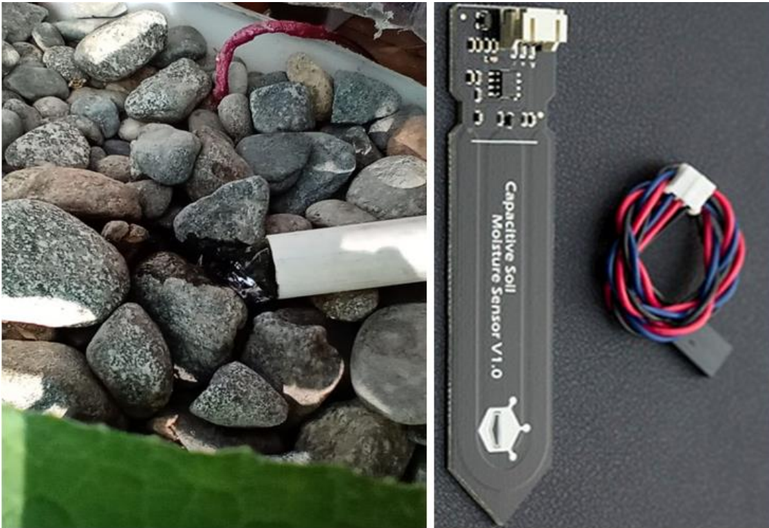
Figura 23 Sensor de humedad implementado en el sistema acuapónico (SEN0193).
