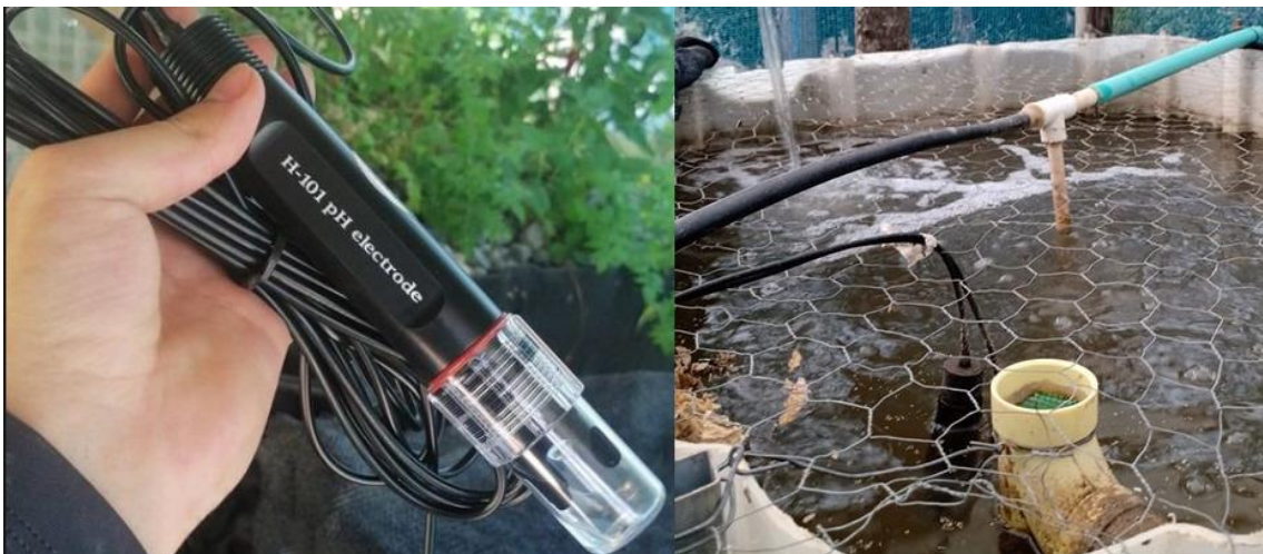
Figura 24 Sensor de pH implementado (SEN0169).
