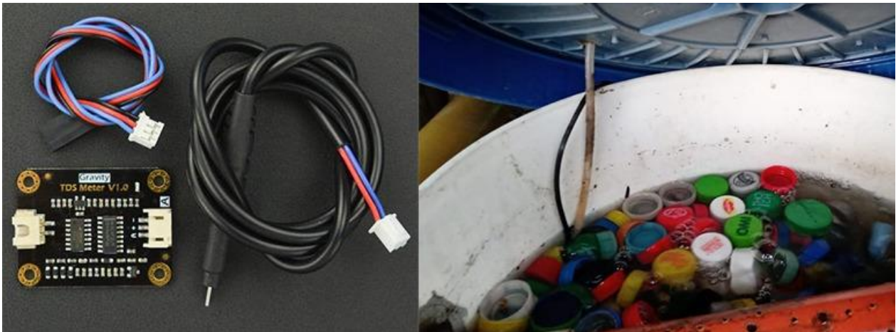
Figura 28 Sensor de TSD implementado (SEN0244).
