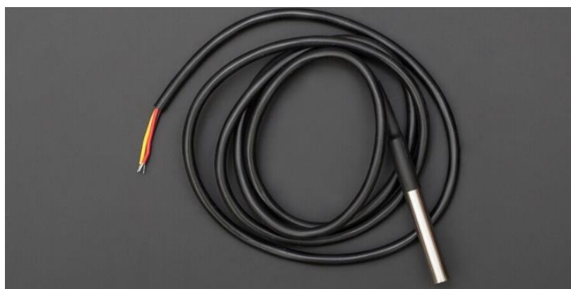
Figura 27 Sensor de temperatura implementado (DS18B20).
