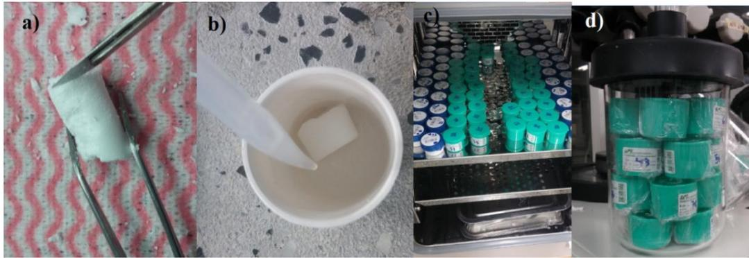
Fig. 23. Fotografías secuenciales de la prueba de degradación hidrolítica, a) Obtención del volumen adecuado de la muestra para la prueba, b) La muestra una vez pesada se expone a SBF, c) La prueba se realiza en una incubadora a 37 °C, d) Finalmente se liofilizan las muestras para realizar el segundo y último pesaje. Autoría propia.
