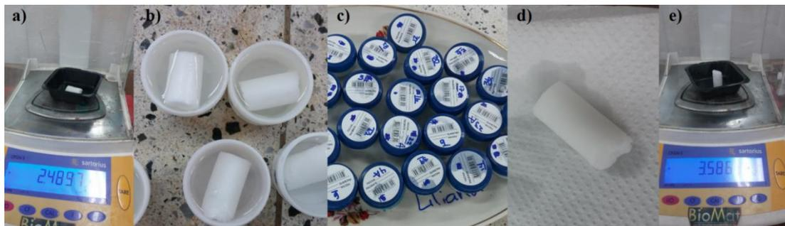
Fig. 24. Fotografías secuenciales de la prueba de absorción, a) La muestra se pesa en seco antes de iniciar la prueba, b) La muestra se somete a un ambiente húmedo c) por 24 h, d) El exceso de agua es retirado con un paño una vez ha pasado el tiempo establecido y e) Las muestras son pesadas nuevamente. Autoría propia.
