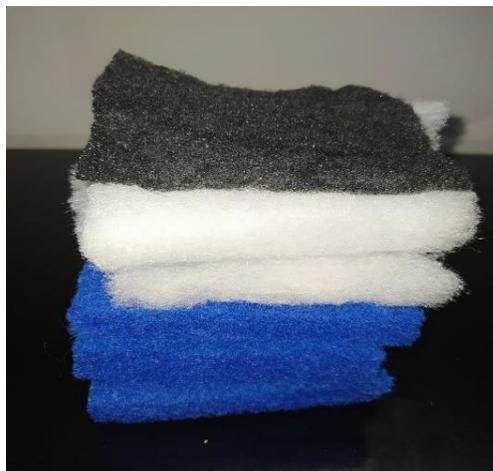
*Figura 6. Materiales para el filtro mecánico*
