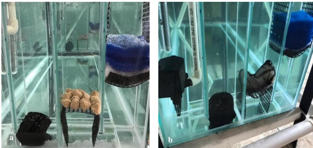
Figura 14. (a) sistema de filtración con sustrato Xport NO<sub>3</sub> (b) sistema de filtración con sustrato *biopellets*.
