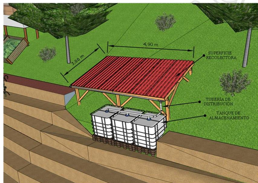
*Figura 19: Recolector Agua Lluvia. Fuente: Sketchup*
