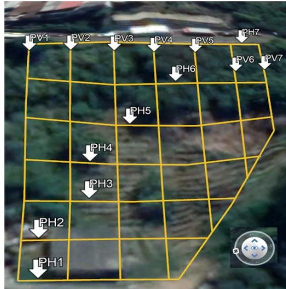
Figura 6: Perfilamiento del terreno para obtención de relieves. PV = Perfil Vertical. PH = Perfil Horizontal.
