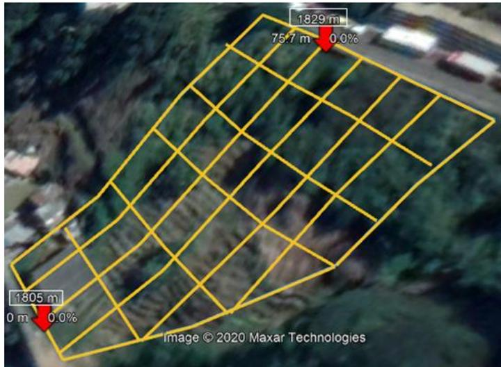
Figura 8: Alturas en puntos extremos de un perfil vertical. Fuente: Google Earth
