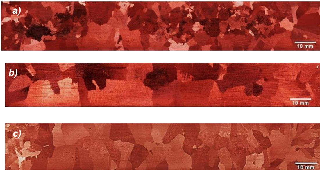
**Figura 22.** Macroestructura de granos de las aleaciones: a)  $\text{Cu}_2\text{Sn}$ , b)  $\text{Cu}_4\text{Sn}$ , c)  $\text{Cu}_8\text{Sn}$ .
