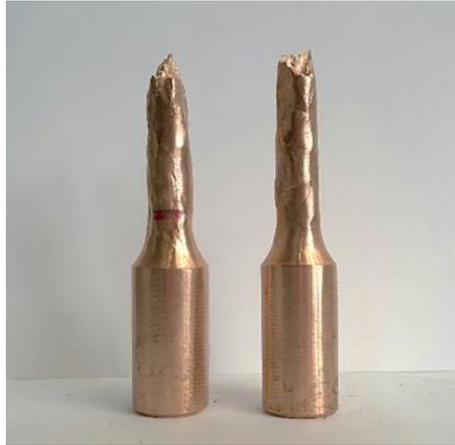
**Figura 42.** Fractura en probeta de tracción: Cu4SnZr.
