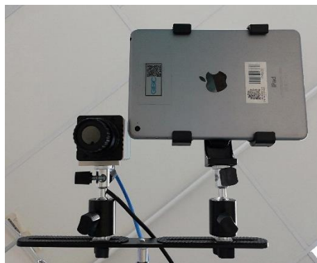
Figura III-6. Vista superior de la ubicación de las cámaras en el riel sujetado al brazo del trípode.
