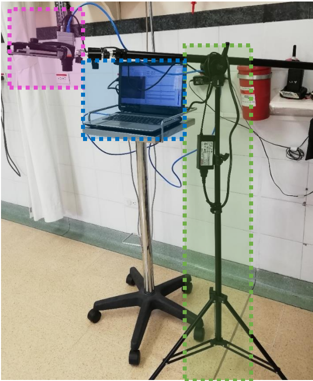
Figura III-7. Montaje de las cámaras en el entorno hospitalario.
