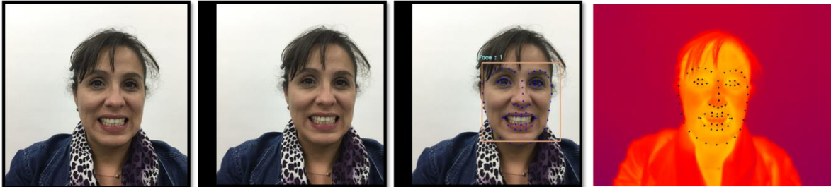
Figura IV-19. Proceso de detección de rostro en imágenes del sujeto de prueba. Imagen original a la izquierda; la imagen se redimensionó y se le realizó la transformación afín a partir de la traslación en x-y con respecto a la imagen térmica; se realizó la detección del rostro y de los puntos de referencia faciales; y por último se ubican las 68-coordenadas en la imagen térmica permitiendo ubicar el rostro.
