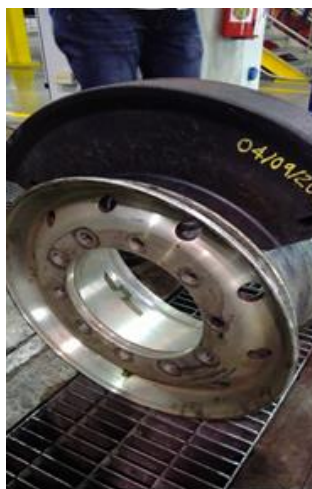
Figura 2. Segmento del dispositivo HUTCHINSON C.R.F 385/65-22,5 x 11,75 montado sobre la llanta ALCOA.
