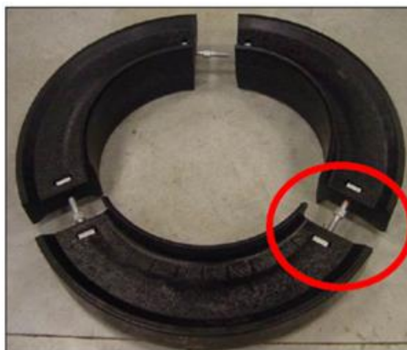
Figura 1. Dispositivo HUTCHINSON C.R.F 385/65-22,5 x 11,75, el círculo en rojo muestra al tornillo M16 [2].
