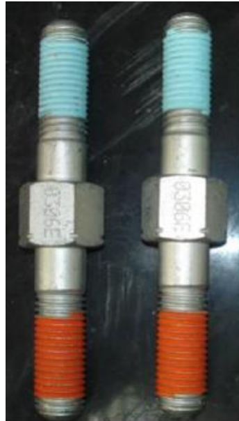
Figura 4. Tornillos HUTCHINSON M16, se pueden apreciar el encapsulado en cada una de las roscas de los vástagos del tornillo; en la rosca izquierda el encapsulado es de color naranja y en la rosca derecha el encapsulado es de color azul [2].
