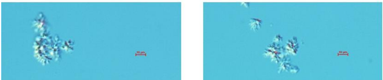
Figura 7. Producto de reacción con ácido fórmico, 4 h, relación molar 1/10 (EGL/AF) y 85 °C.
