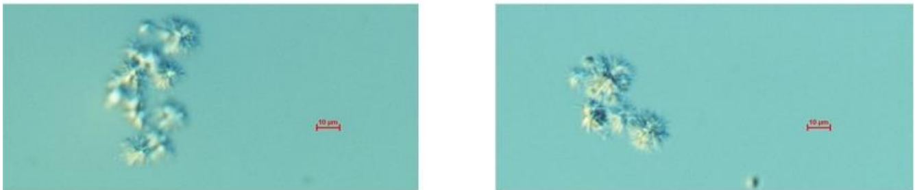
Figura 9. Producto de reacción con ácido fórmico, 1 h, relación molar 1/100 (EGL/AF) y 115 °C.
