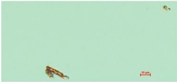
Figura 61. Microscopia óptica inversa de B10 con 100 ppm de EGL en día 50.
