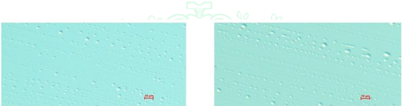
Figura 23. Microscopia óptica inversa de B100D con 20 ppm de EGL en día 0.
