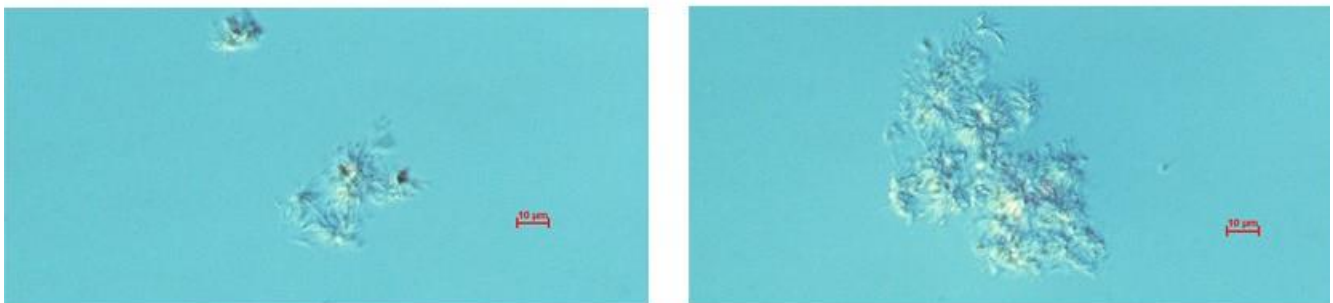
Figura 7. Imágenes de microscopía óptica inversa de la muestra de B100D con 100 ppm de EGL.
