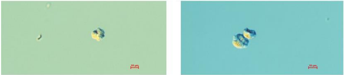
Figura 31. Microscopia óptica inversa de B100D con 50 ppm de EGL en día 50.
