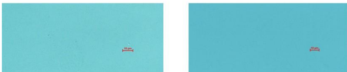
Figura 13. Producto de reacción con ácido fórmico, 2 h, relación molar 1/2000 (EGL/AF) y 115 °C.
