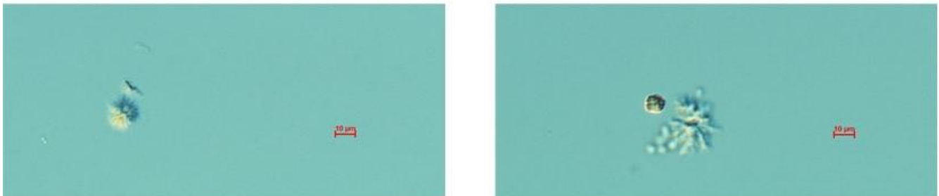
Figura 10. Producto de reacción con ácido fórmico, 2 h, relación molar 1/100 (EGL/AF) y 115 °C.
