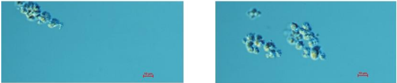
Figura 35. Microscopia óptica inversa de B100D con 100 ppm de EGL en día 14.
