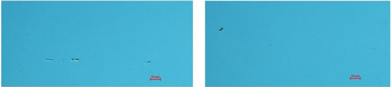
Figura 20. Microscopia óptica inversa de B100D con 10 ppm de EGL en día 14.
