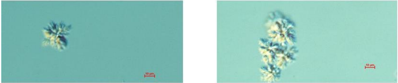
Figura 8. Producto de reacción con ácido fórmico, 4 h, relación molar 1/100 (EGL/AF) y 85 °C.
