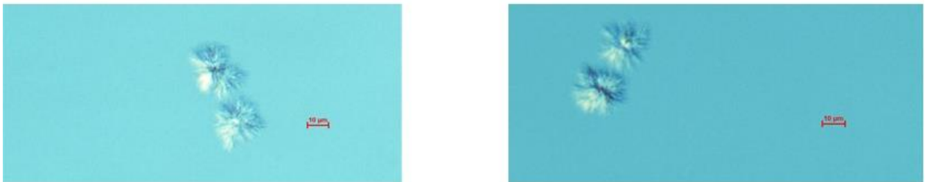
Figura 15. Producto de reacción con anhídrido acético, 4 h, relación molar 1/100 (EGL/AA) y 85 ° C.
