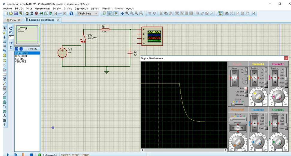
figura 8. Simulación Descarga de un condensador electrolítico con Proteus 8.5
