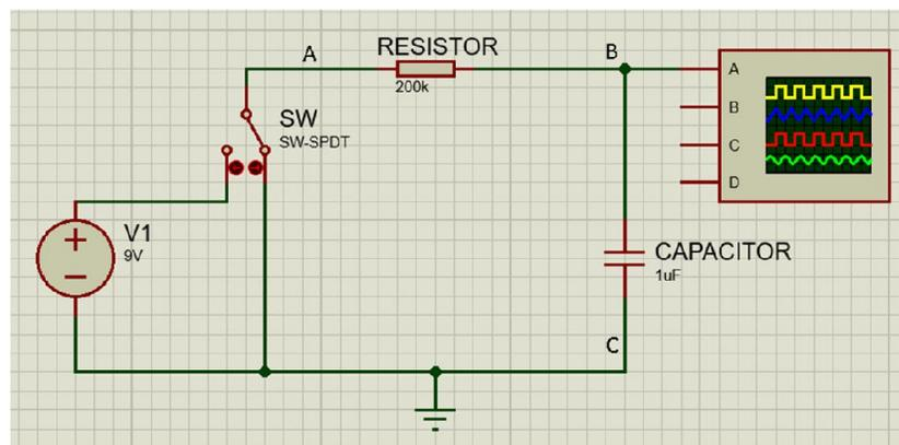
figura 5. Diagrama Circuito RC
