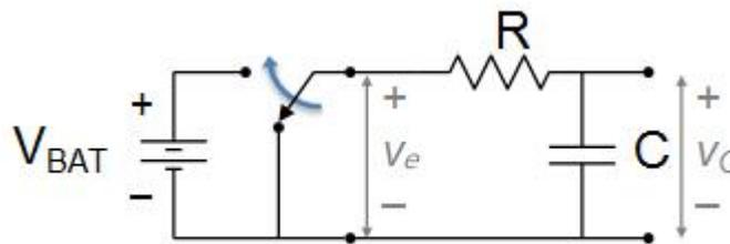
En Proteus 8.5, diseña el montaje propuesto en la figura 6. Con ayuda del osciloscopio describe el tipo de gráfica que se muestra y cómo cambia al variar el valor de la resistencia y del condensador.
