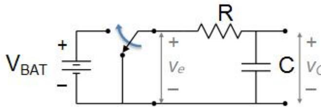
figura 1. Diagrama Circuito RC
