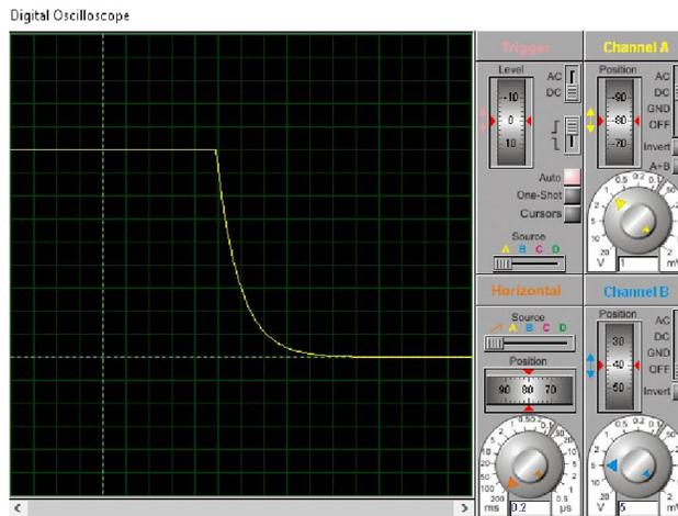
A partir de la gráfica que provee la pantalla del osciloscopio, el estudiante puede tabular los puntos del plano coordenado en una hoja de cálculo. Por ejemplo, para el caso de la figura 9, la escala del eje vertical está de 1 voltio por cuadro y el eje horizontal de 0.2 segundos por cuadro.
