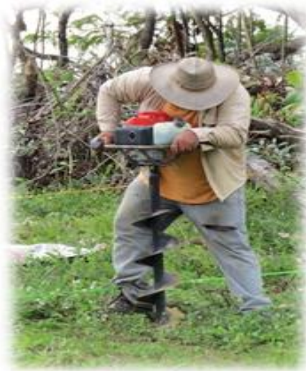
Figura 13. Apertura de hoyos con máquina hoyadora Fuente: Tomado de Murgueitio (2019). Informe Colciencias.
