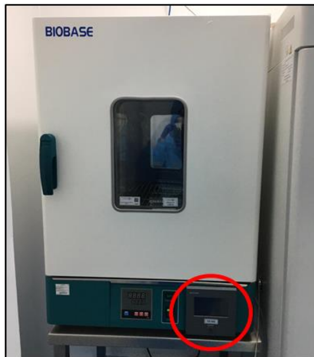
Figura 12. Horno de pasteurización modificado. Nota: en el círculo rojo se muestra la modificación que se realizó [Realización propia].
