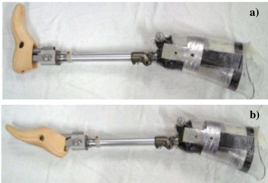
*Figura 8.* Prótesis transfemoral con articulación del tobillo móvil accionado por resorte que permite el rango de movimiento representado de *a)* dorsiflexión (caminar) a *b)* plantiflexión (nadar) (Nakashima et al., 2013).
