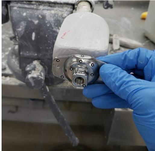
Figura 28. Proceso de fabricación de la base: molde en yeso y componente macho en el extremo proximal previo al termoformado.
