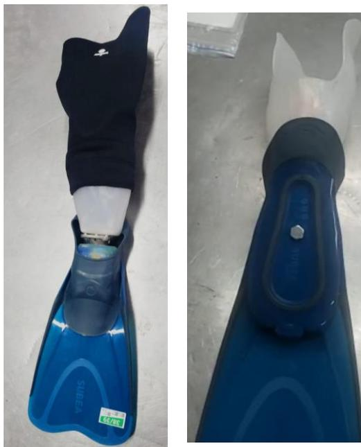
Figura 29. Prototipo terminado de la *Alternativa C*, socket termoformado y aleta comercial.
