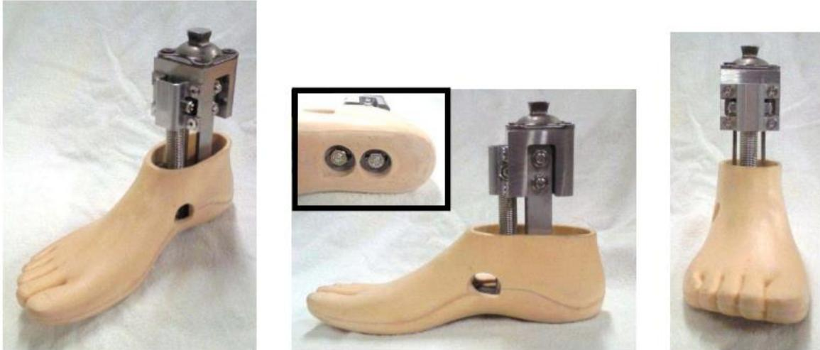
*Figura 9.* Prótesis de tobillo que permite caminar y nadar, es completamente móvil y su movilidad se debe a un resorte ubicado en la parte frontal de la articulación del tobillo (Nakashima et al., 2013).
