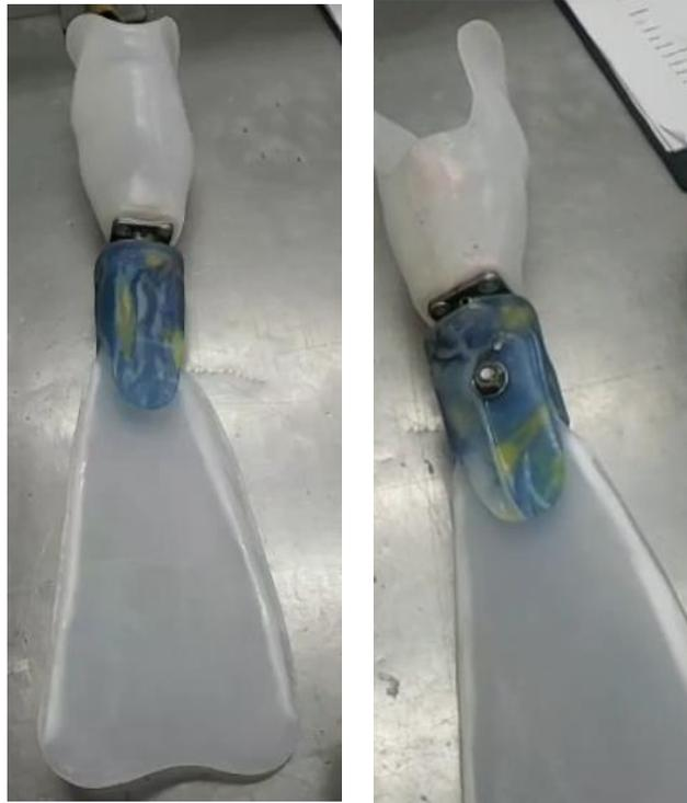
Figura 30. Prototipo terminado de la *Alternativa D*, socket y aleta termoformados.
