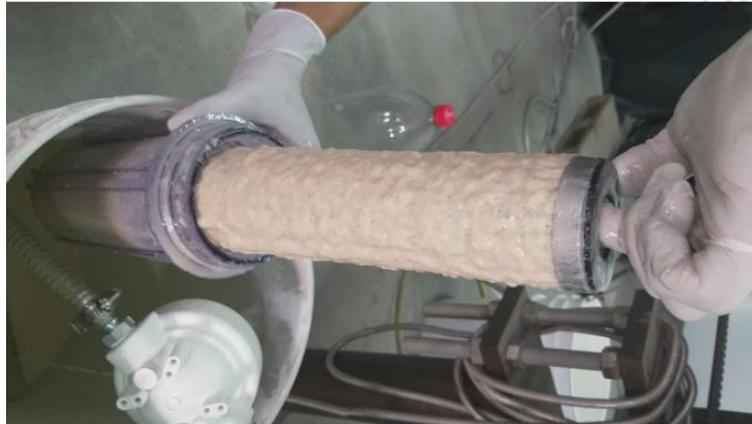
*Figura 12 Elemento MESH 250 filtrante saturado de sólidos*
