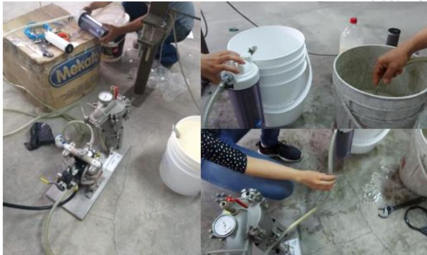
Figura 10 Montaje de filtración con carcasa
