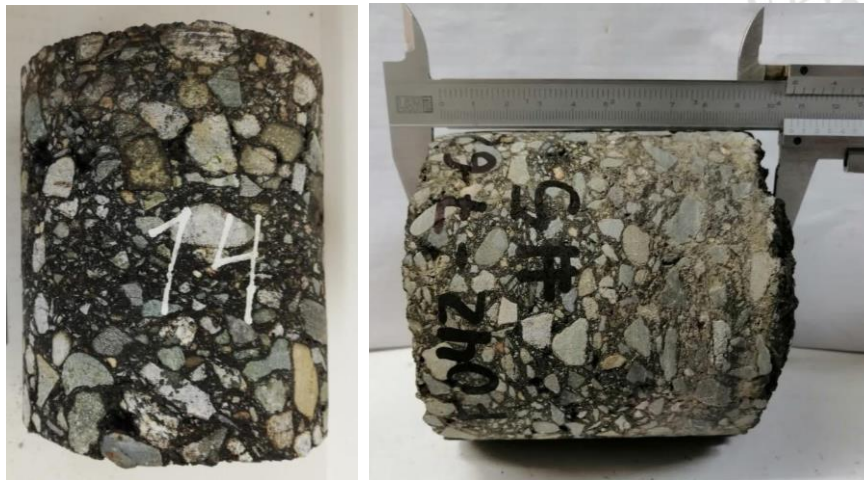
Imagen 6. Núcleos asfálticos extraídos de pavimento, mezcla tipo MDC-19. Fuente: Elaboración propia.
