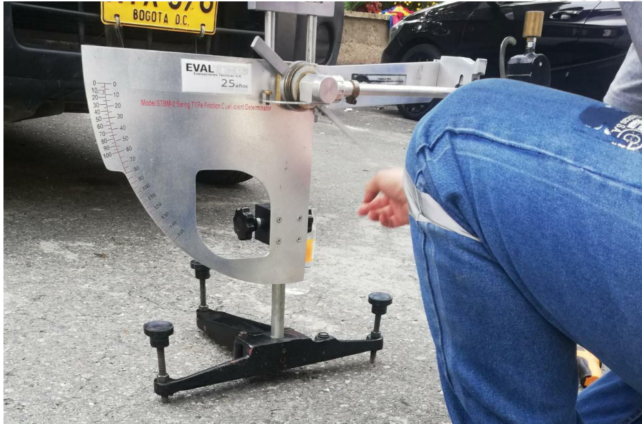
Imagen 7. Péndulo británico para determinar la resistencia al deslizamiento. Fuente: Elaboración propia.
