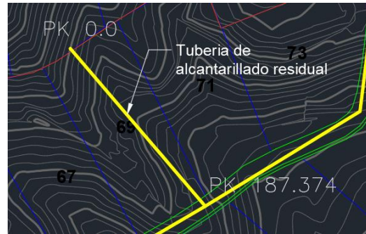
Imagen 3b Trazado incorrecto de alcantarillado residual entre linderos de lote. Elaboración propia
