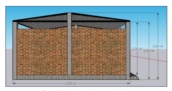
Figura 10. Vista lateral del centro de acopio.
