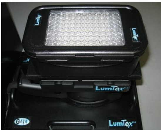
Figura 7. Agitador de microplatos del equipo LumTox.
