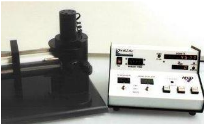
Figura 3. Tubo fotomultiplicador del equipo comercial Qwiklite®
