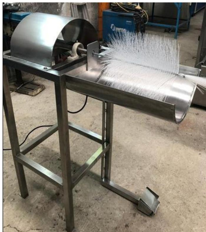
Ilustración 8 dispositivo con motor y escobillón para instalar en el centro de lavado
