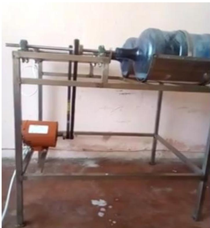
Ilustración 9 dispositivo con el motor y poleas para instalar en el centro de lavado
