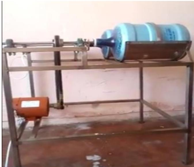
Ilustración 7 dispositivo con motor y poleas a instalar en el centro de lavado
