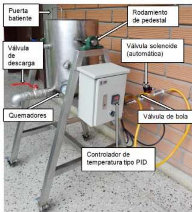
Fig. 1: Marmita cilíndrica diseñada para la extracción de aceite de vísceras de tilapia roja (*Oreochromis sp.*).
