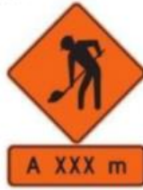
Ilustración 11 Trabajos en la vía
