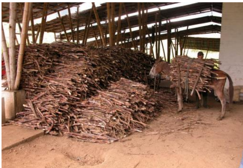
Figura 8. Técnica de almacenamiento de la caña en el trapiche.
