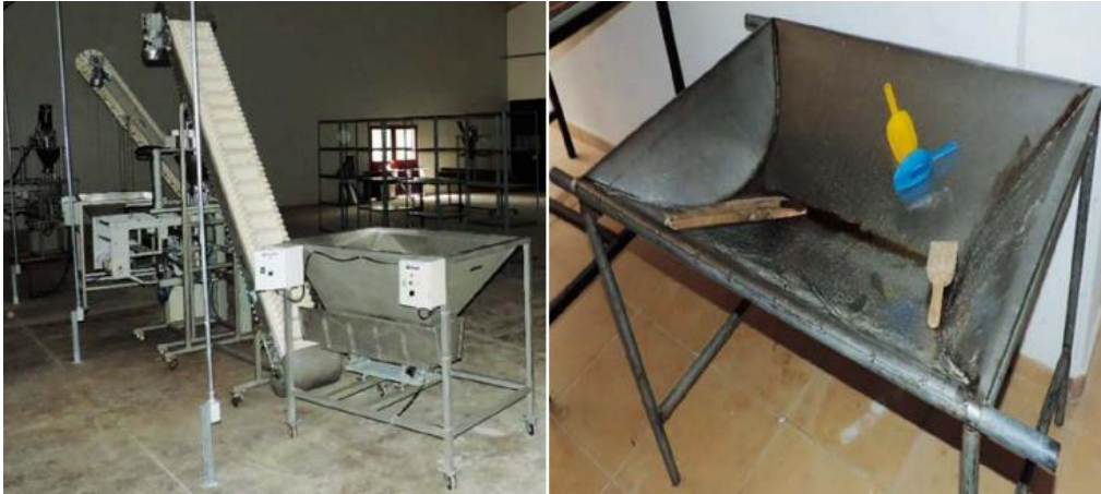
Figura 22. Envasado mecánico y envasado manual.
