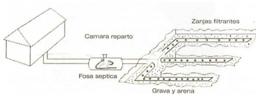
Figura 19. Sistema de tratamiento con franjas filtrantes.
