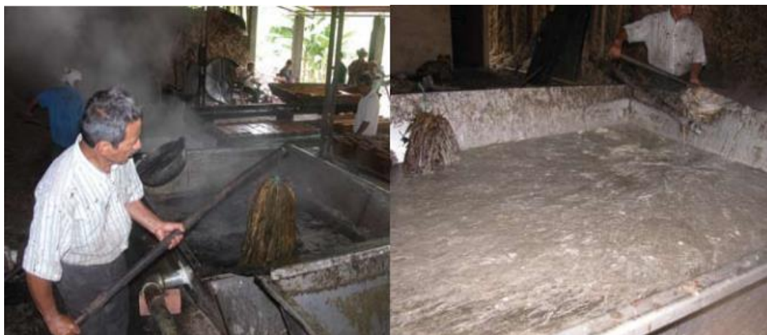
Figura 10. Etapa de pre-limpieza de los jugos y separación manual de la cachaza. Fuente: CORPOICA – Tibaitatá, 2006.
