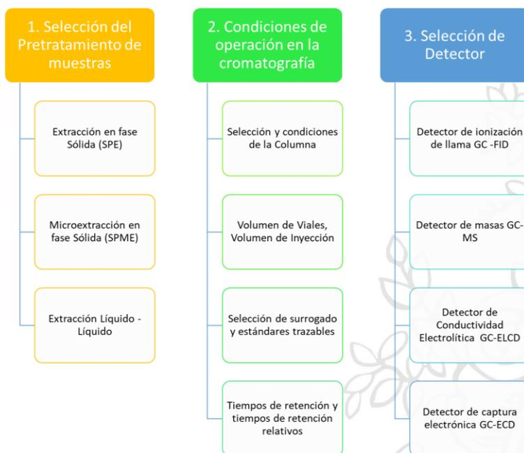
**Ilustración 1.** Pasos para la estandarización y puesta a punto de técnicas o métodos analíticos cromatográficos.
