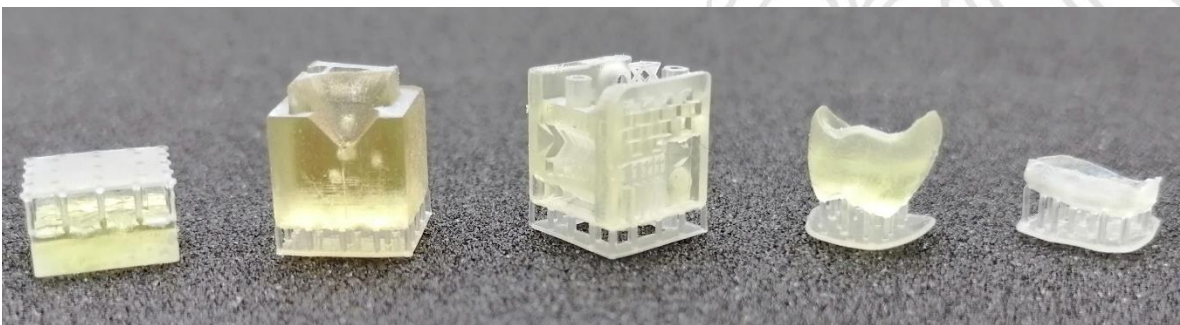
Figura A.5.3. Probetas de caracterización y piezas dentales elaboradas por impresión 3D SLA-DLP a partir de formulaciones preliminares.
