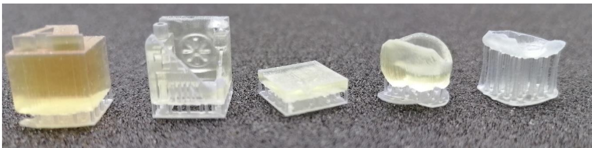
Figura 13. Probetas de caracterización y piezas dentales elaboradas por impresión 3D SLA-DLP a partir de formulaciones preliminares (Fuente propia).
