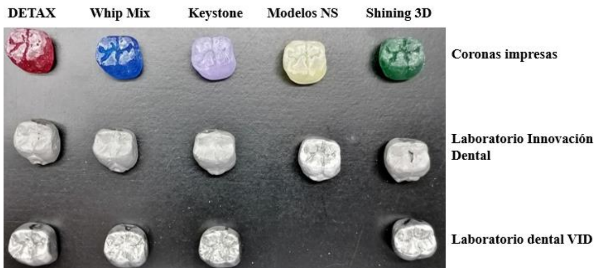
Figura 10. Coronas dentales obtenidas por proceso de colado por los laboratorios de Innovación dental y dental VID (Fuente propia).
