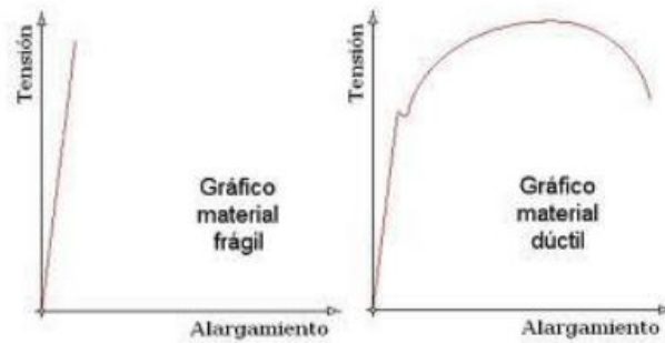
Figura 1. Comportamiento de un material dúctil vs un material frágil (Universidad Tecnológica del Pereira)
