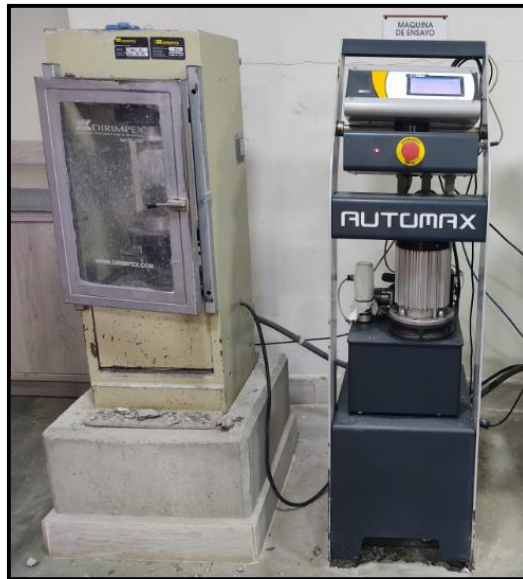
Figura 2. Prensa hidráulica para el ensayo de resistencia a la compresión. Elaboración propia.
