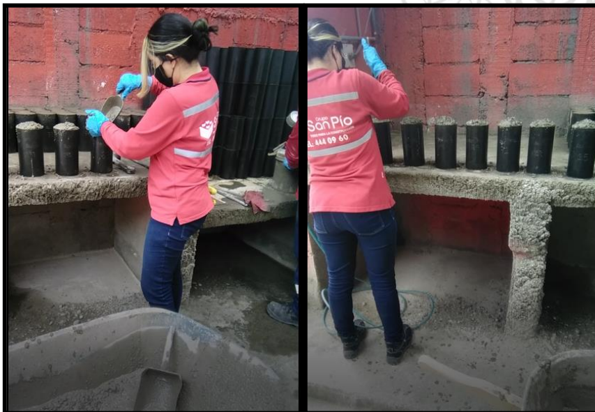
Figura 1. Proceso de muestreo de las mezclas de concreto fresco. Elaboración propia.
