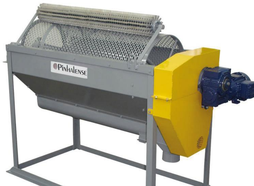
Figura 14. Equipos Nro. 17, 18. Cribas Rotativas para separar granos por tamaño
