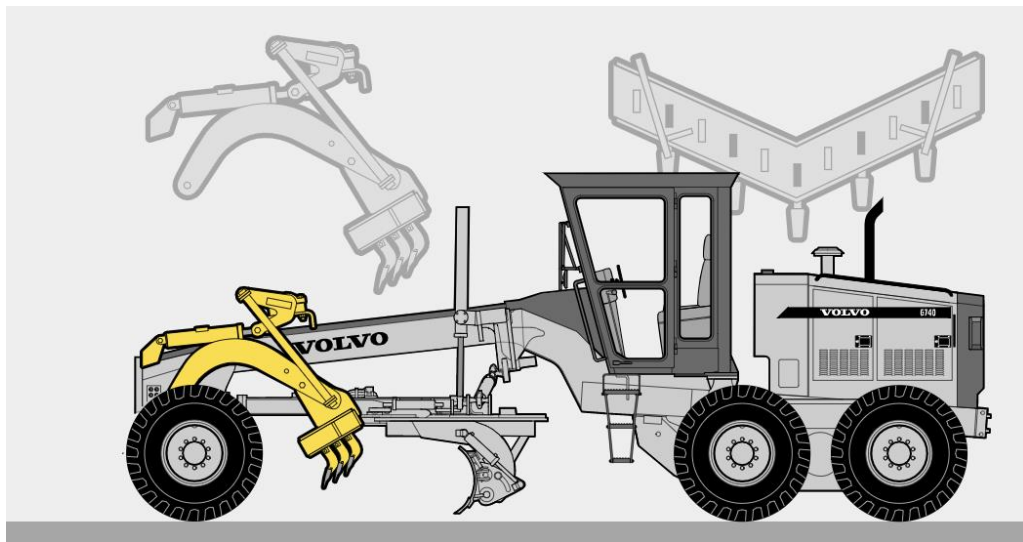
Figura 3. Herramienta escarificadora en motoniveladora. Fuente: (volvoce.com)
