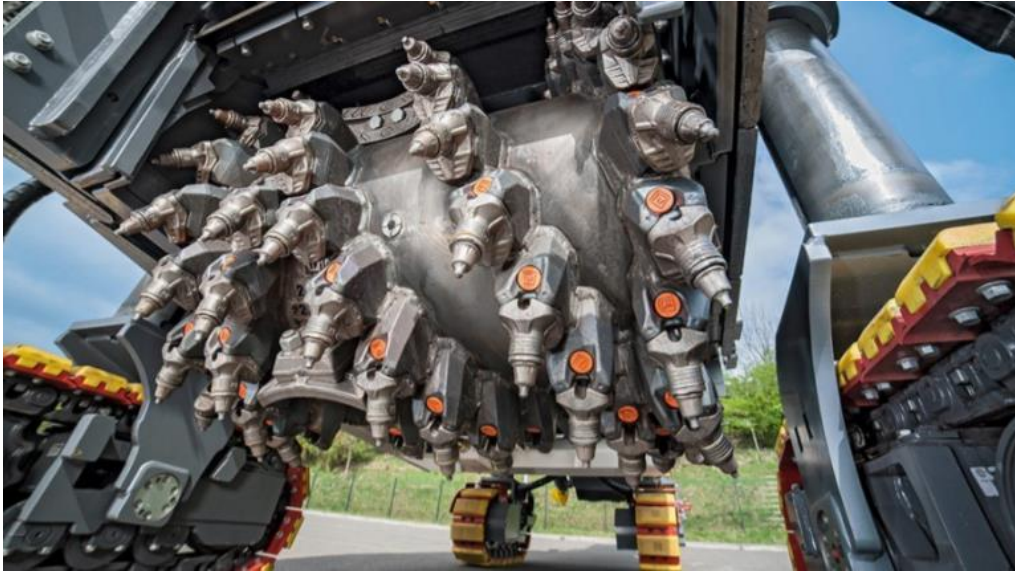
Figura 4. Herramienta fresadora. Fuente: El mundo de las fresadoras en frío de Wirtgen.
