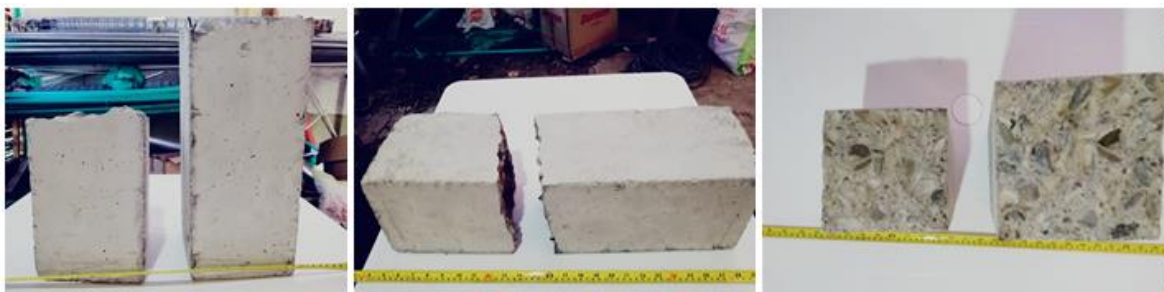
Figura 19. Viga con macro fibra LDPE-R, fallada.
