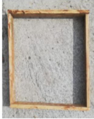
Figura 11. Formaleta de madera para placas de concreto.
