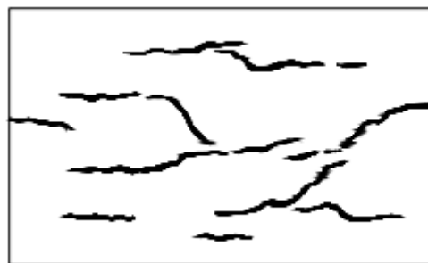
Figura 7. Fisuración típica por retracción plástica [22].
