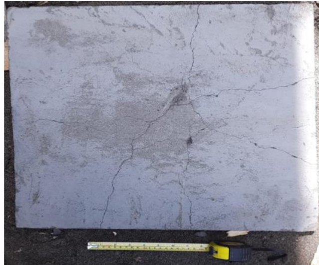
Figura 20. Losa de concreto sin refuerzo (blanco).
