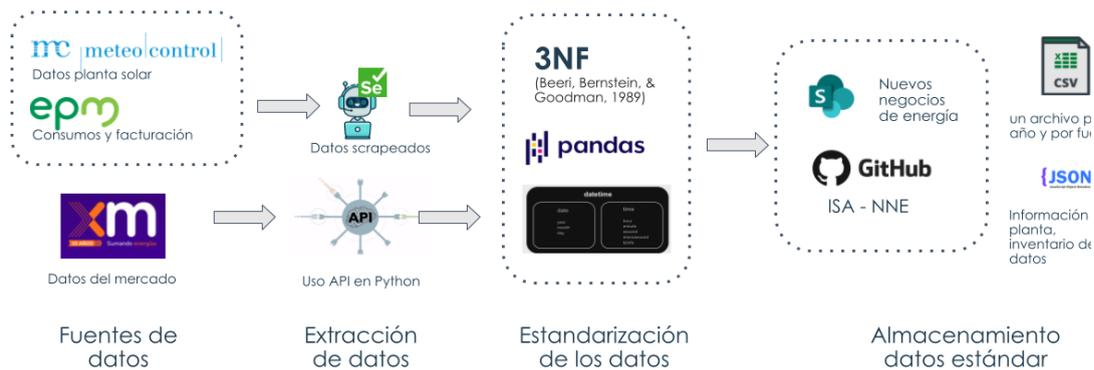
Figura 28: Arquitectura de automatización del proceso
