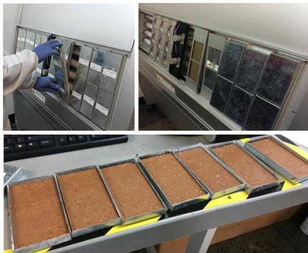
**Figura 2.6.** Porta muestras para exposición de probetas rectangulares en la cámara intemperismo acelerado
