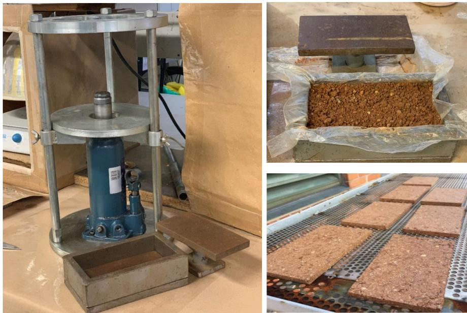
**Figura 2.4.** Molde y gato hidráulico para compactación de probetas rectangulares
