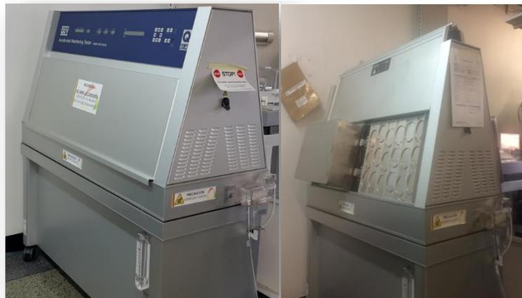
**Figura 1.10.** Cámara de envejecimiento acelerado
