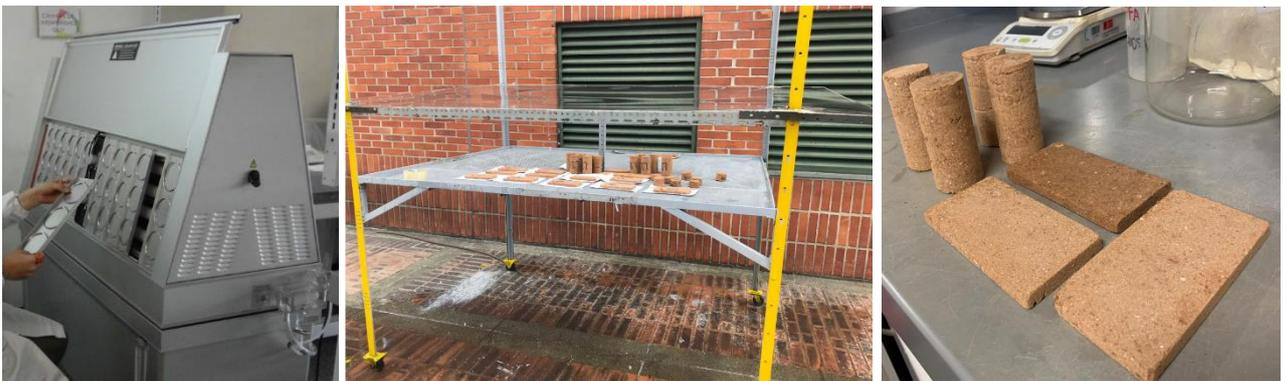
Figura 2.14. Probetas sometidas a la diferentes condiciones de intemperismo
