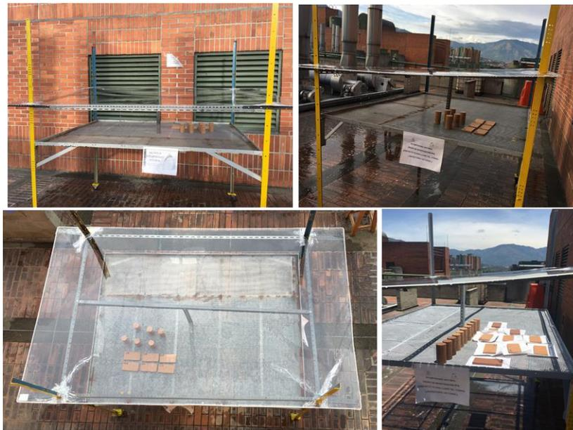
Figura 2.7. Montaje para exposición de probetas a intemperismo natural
