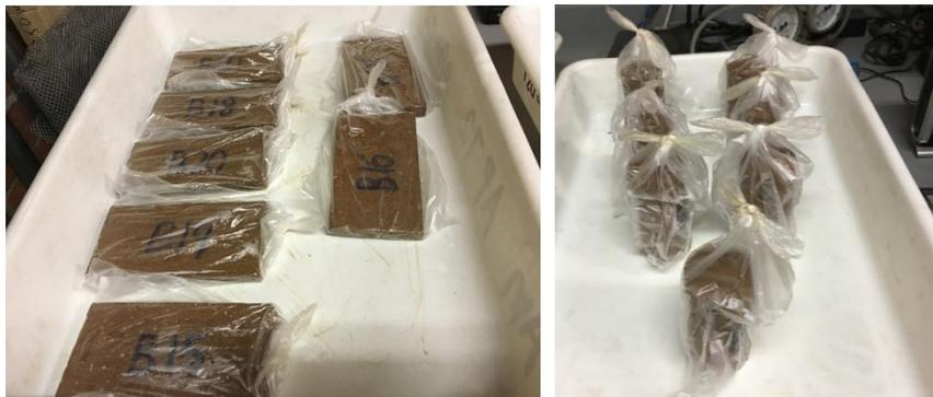
Figura 2.13. Proceso de curado de probetas moldeadas
