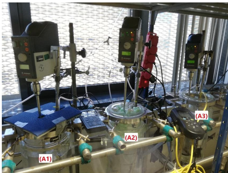
Fotografía 2: Montaje de la segunda serie de experimentos. Reactor A1 con tapa de espuma, A2 con styrofoam y A3 sin tapa
