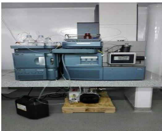
*Figura 10.* Sistema cromatográfico líquido con acople a espectrometría de masas de alta resolución tipo Trampa de Iones con Tiempo de Vuelo (UPLC-Q-TOF)
