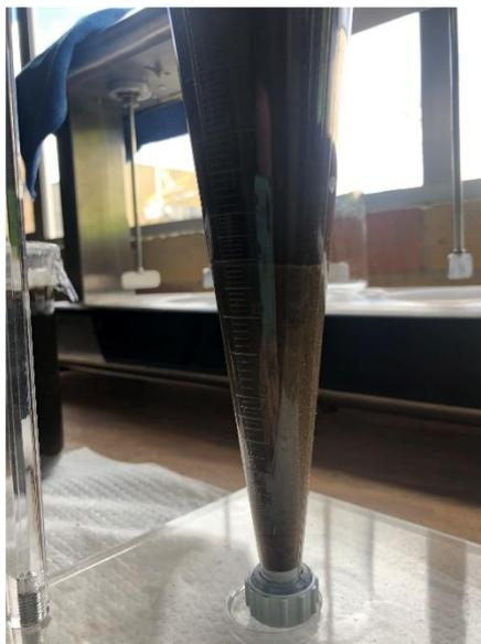
**Figura 3.** Prueba 1. Medición de sedimentación en cono Imhoff
