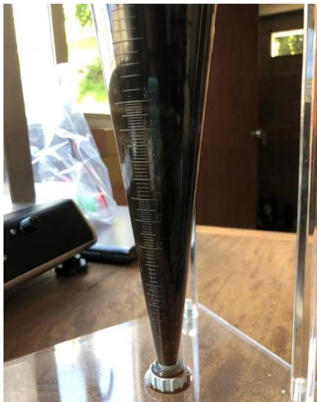
**Figura 6.** Prueba 2. Medición de sedimentación en cono Imhoff
