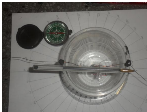
Fotografía 10: Vista superior del montaje del experimento. Nótese la ubicación de la brújula, el papel graduado y el cable con espiras
