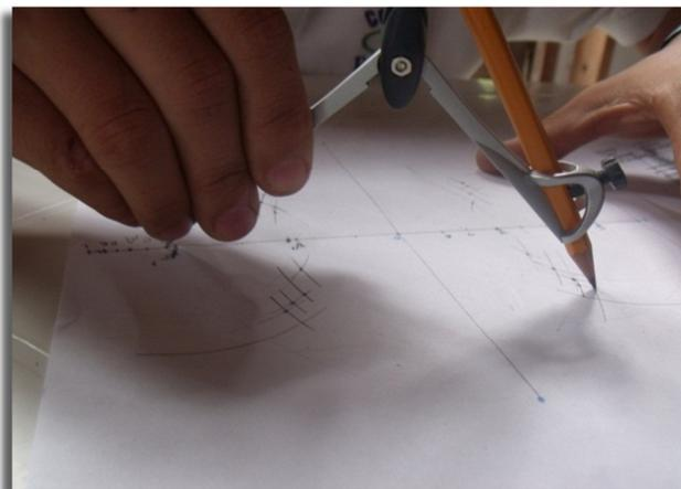
*Ilustración 12: Construcción las secciones cónicas con regla y compás.*
