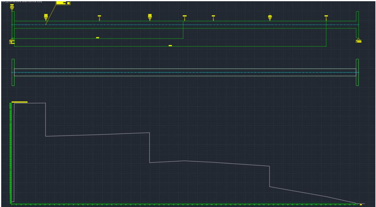
Ilustración 25 Entorno de AutoCAD Mechanical -Grafico de Von Mises VS mm
