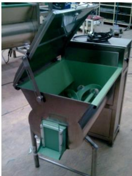
Ilustración 3 Máquina de hilado con agitador de aspas helicoidales
