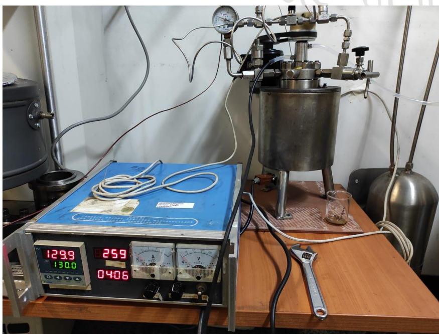
Ilustración 21. Montaje experimental para la reacción de carbonatación de GDMCO epoxidado en reactor de 140 mL
