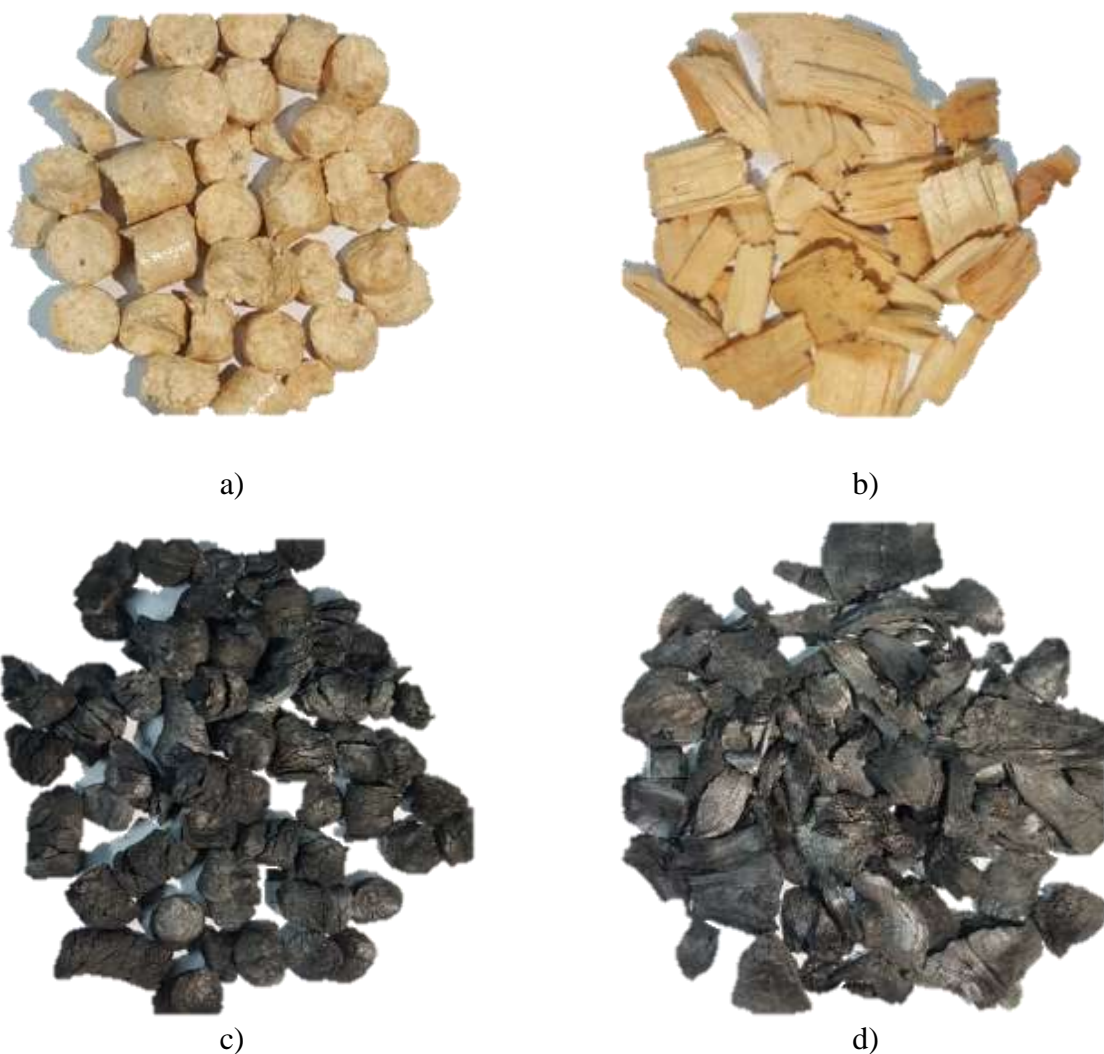
Figura 4.1. Biomasa cruda y biocarbones producidos. a) WP, b) WCH, c) WP-BC y d) WCH-BC. El proceso de gasificación se realizó en un reactor de lecho fijo equicorriente ( reverse downdraft , o top-lit updraft - TLUD ) a presión atmosférica, obteniendo como productos gas combustible y BC. El reactor TLUD, cuya geometría era cilíndrica de altura 0.28 m y 0.16 m de diámetro interior, contaba con una línea de suministro de aire (agente gasificante) compuesta por un compresor recíprocante (2.6 kW, 3000 rpm, hasta 254 L/min), un rotámetro y un manómetro para controlar el flujo y la presión de aire, respectivamente. Se utilizó un flujo de aire fijo de 146 \pm 4.35 L/min para la gasificación de los WP y las WCH. La temperatura del proceso se monitoreó mediante 5 termopares tipo K ( \pm 1 °C) separados 0.04 m cada uno de ellos a lo largo del reactor. La instalación experimental
