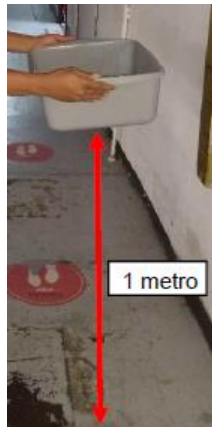
Figura 19. Imagen del ensayo de caída libre sin carga con una distancia de 1 metro.
