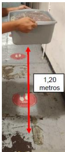
Figura 20. Imagen del ensayo de caída libre con carga con una distancia de 1.20 metro.
