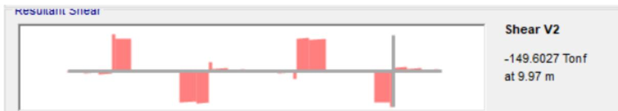
**Figura 33.** Cortante de diseño por combinación de Resistencia máx., con SAP2000
