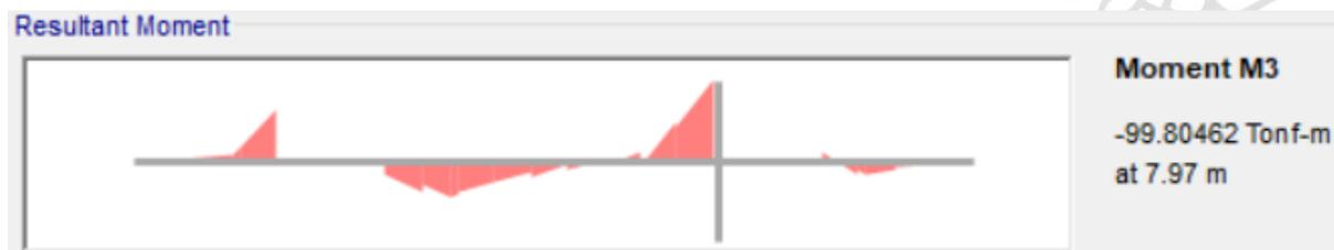
**Figura 34.** Momento de diseño por combinación de evento extremo máx., con SAP2000
