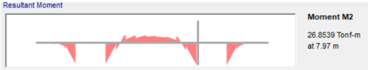
**Figura 37.** Momento de diseño por combinación de evento extremo máx., con SAP2000
