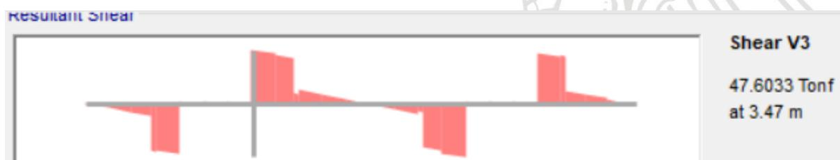
**Figura 36.** Cortante de diseño por combinación de Evento extremo máx., con SAP2000
