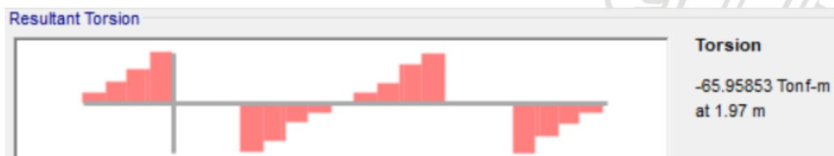
**Figura 35.** Torsión de diseño por combinación de Resistencia máx., con SAP2000
