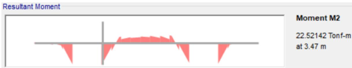
**Figura 21.** Momento de diseño por combinación de evento extremo máx., con SAP2000
