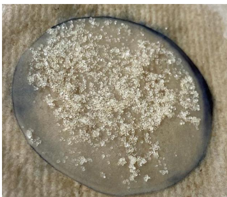
Figura 36. Cristales de azúcar luego de ser lavados
