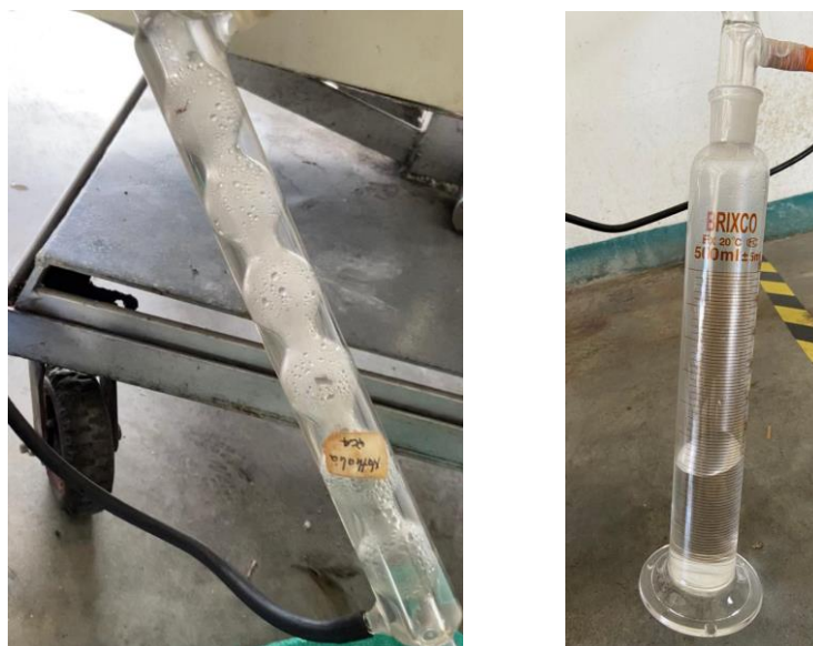
Figura 18. Sistema de condensación
