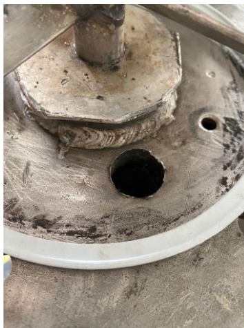
Figura 22. Empaque de caucho acoplado en la tapa del tanque
