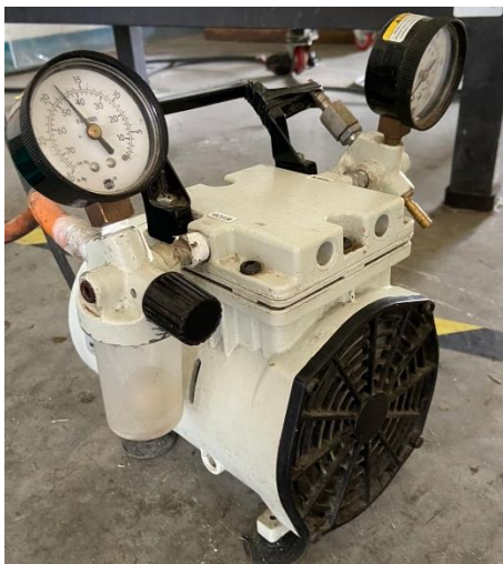
Figura 16. Bomba de vacío
