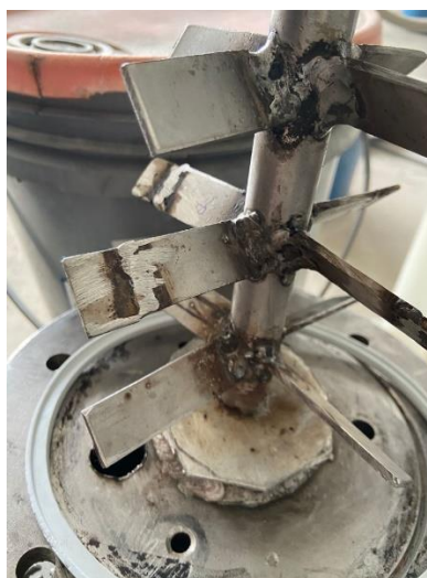
Figura 25. Extensión en las paletas de agitación
