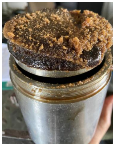
Figura 35. Masa comprimida luego de filtrada
