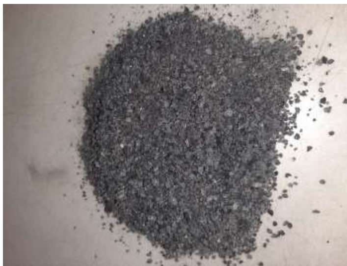
Fig. 4. Muestra de coque metalúrgico preparada
