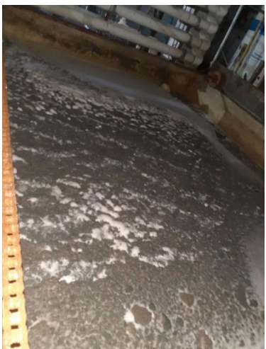
Ilustración 5. Celda de flotación.
