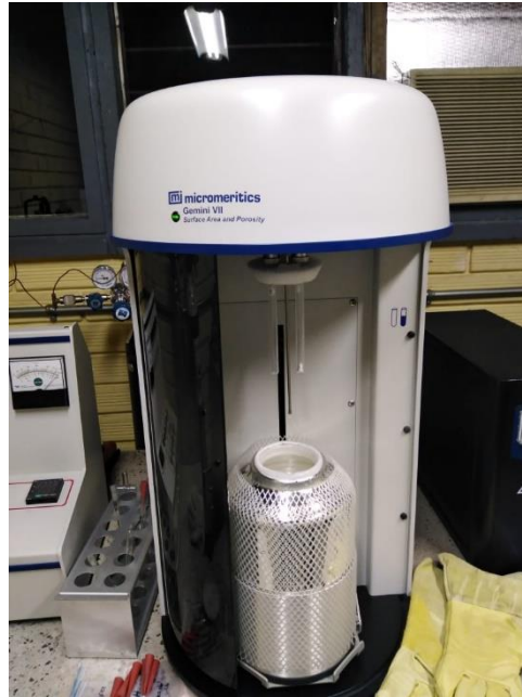
Fig. 11 Analizador micromeritics Gemini VII para el área superficial
