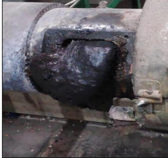
Fig.39. Material plastificado saliendo por el respirador del husillo. Foto tomada en la empresa Bioplast de Antioquia S.A.S.
