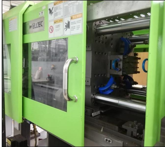
Fig.17. Máquina inyectora utilizada para el procesamiento por inyección. Foto tomada en el SENA sede Calatrava- centro de diseño y manufactura del cuero.
