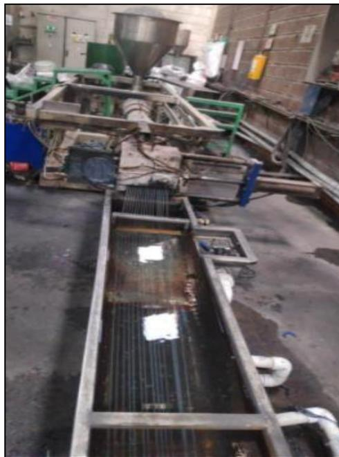
Fig.15. Proceso de extrusión-peletizado utilizado para el procesamiento del material de asiento. Foto tomada en la empresa Bioplast de Antioquia S.A.S.
