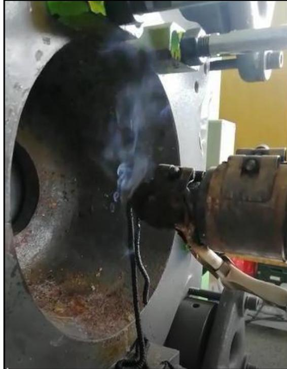
Fig.44. Humo generado en la boquilla de inyección. Foto tomada en el SENA sede Calatrava- centro de diseño y manufactura del cuero.
