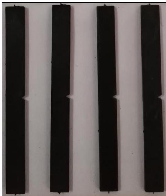
Fig.43. Probetas obtenidas por inyección con el perfil de temperatura alto.
