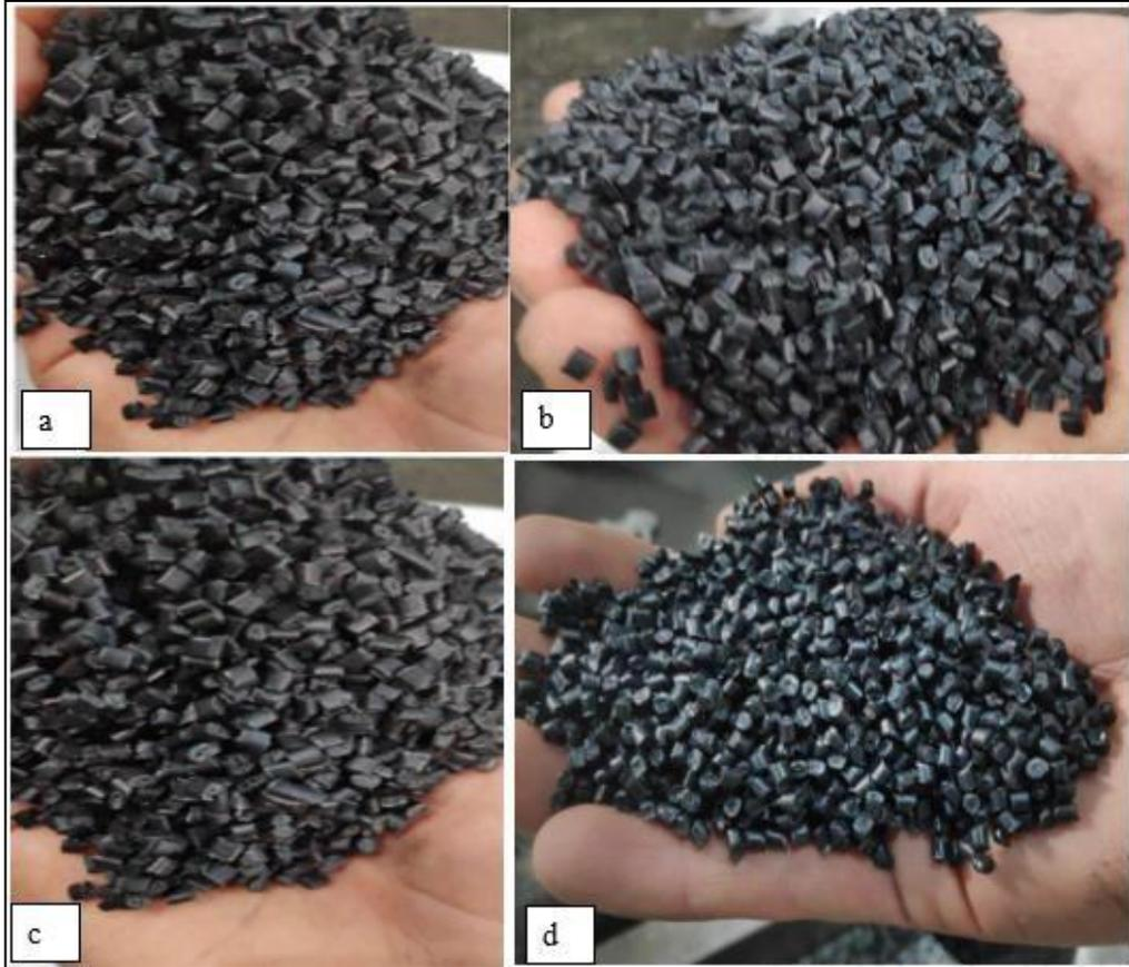
Fig.40. Apariencia de los pellets obtenidos para a) lote 1, b) lote 2, c) lote 3 y d) referencia. Foto tomada en la empresa Bioplast de Antioquia S.A.S.
