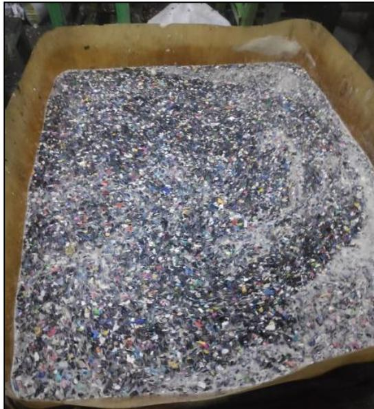
Fig.14. Material de asiento en la superficie del tanque listo para ser separado.
