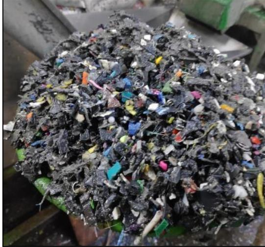
Fig.12. Material precipitado en el tanque de decantación.
