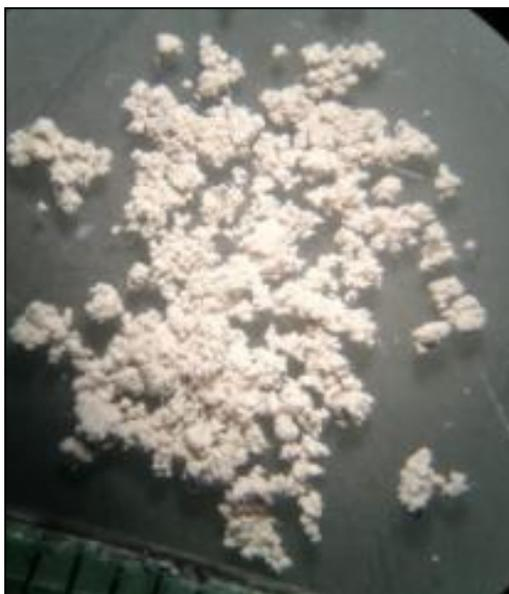
Fig.46. Residuo de calcinación de los pellets de material de asiento. Foto tomada en el Laboratorio de Fundición de la Universidad de Antioquia.
