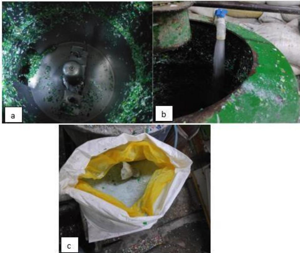
Fig.10. Sistema de lavado propio de la empresa BIOPLAST DE ANTIOQUIA S.A.S. a) recipiente metálico y cuchillas, b) sistema de alimentación de agua y c) jabón sólido.
