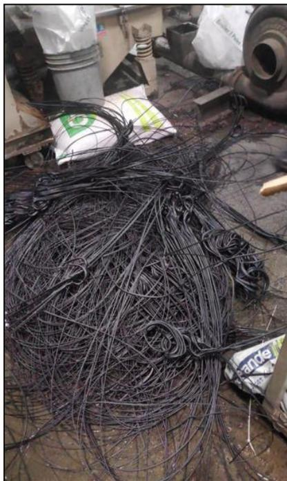
Fig.41. Rafia generada por la dificultad de poner a punto el proceso de peletización. Foto tomada en la empresa Bioplast de Antioquia S.A.S.
