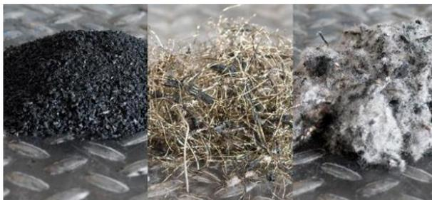
Nota: Obtención de caucho, acero y textiles a través del proceso de trituración.
