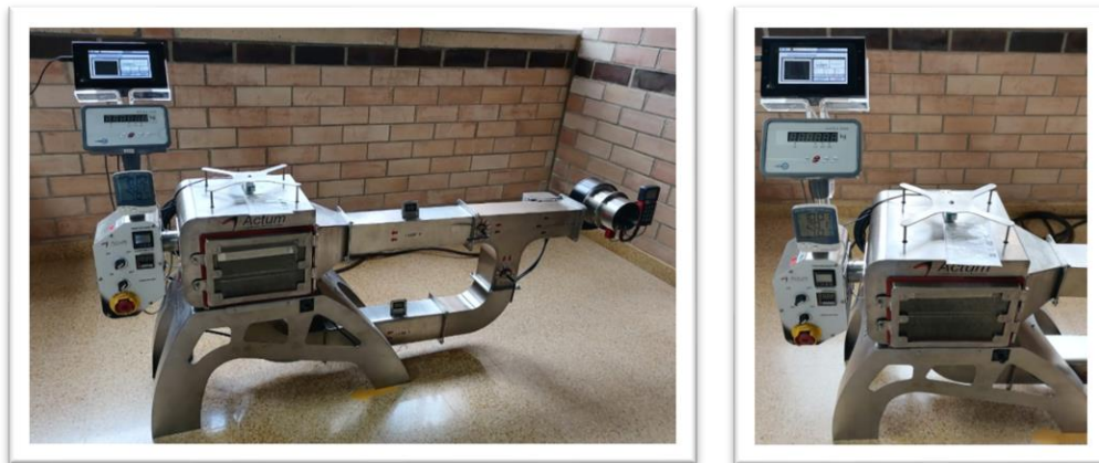
Fig. 27. Módulo de adquisición de datos ubicado en el equipo de secado
