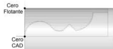
Fig. 5: Sobredimensionado de la pieza.
