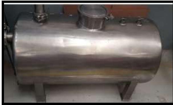
Imagen 9. Tanque de retorno, Doy pack automática Panal S.A.S Fuente: Planta Panal S.A.S
